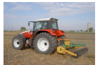
Steyr 9125a (92 kW) mit Unterbodenlockerer 4 feste Zinken, 3 m Arbeitsbreite
